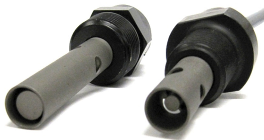
Sensores de conductividad: izquierda, electrodos convencionales con espaciado estrecho; derecha, mayor espaciado disponible en los sensores UniCond
